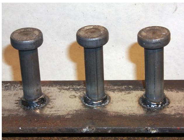
Obr. 16 Spřahovací trny
