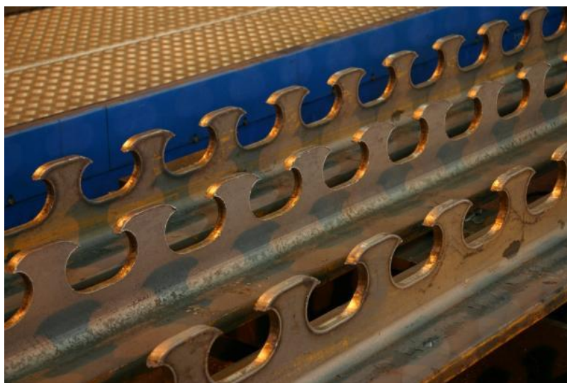
Obr. 18 Alternativní možnost tvaru spřahovací lišty
